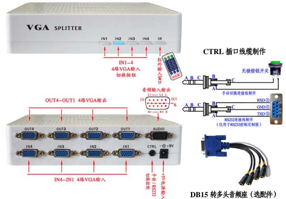
按以上图示连接电脑及显示器，如需要连接音频输入及功放输出的，需要配一个母 DB15 插头，按以上标示的连接上即可，或者选配我司定制的 DB15 转多头音频插头的专用线缆如上图，直接插到 AUDIO 口上，线上标有 1-4 的为 IN1-4 的双声道音频输入，未标数字的为双声道音频输出。
